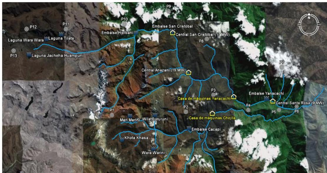
El proyecto considera la instalación del embalse Hierbani, a una altura de 2740 m.s.n.m. sobre el río Unduavi, que permitirá contar con un caudal regulado de 3.8 m<sup>3</sup>/s a través de una tubería de gravedad de 6,189 m de longitud y una tubería forzada hasta la casa de máquinas, ubicada próxima a la localidad de San
